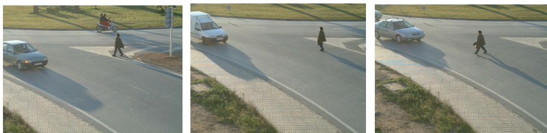
Secuencia de paso de una persona en un cruce de la circunvalación de Ibiza. A pesar de disponer de un paso de peatones elevado, al estar situado fuera del eje del cruce, los peatones prefieren cruzar en línea recta, a pesar del riesgo
